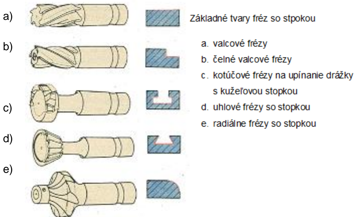
Obr.3.4 Stopkové frézy
