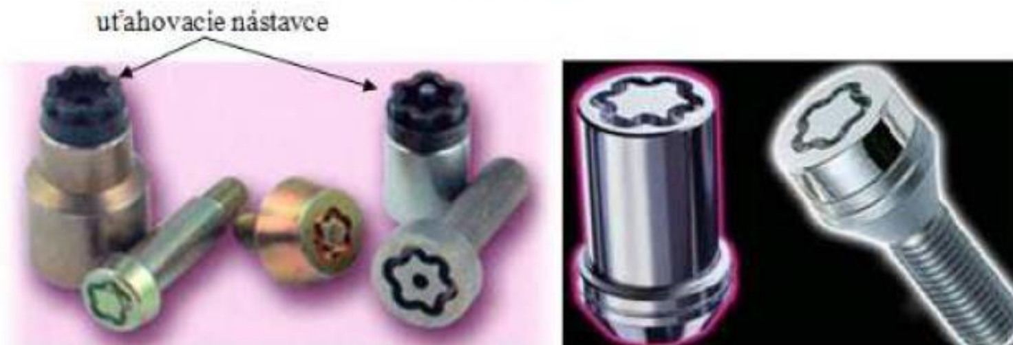
Obr. 1.13 Špeciálne skrutky so špeciálnym vybráním v hlavách s dvojitým profilom typu Torx pre vnútorný a vonkajší dotyk pri uťahovaní uťahovacími nástavcami
