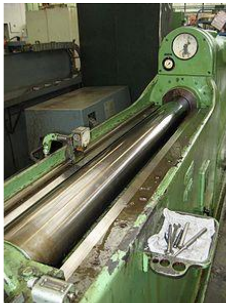
Obr.5.13 Hydromotor horizontálnej preťahovačky
