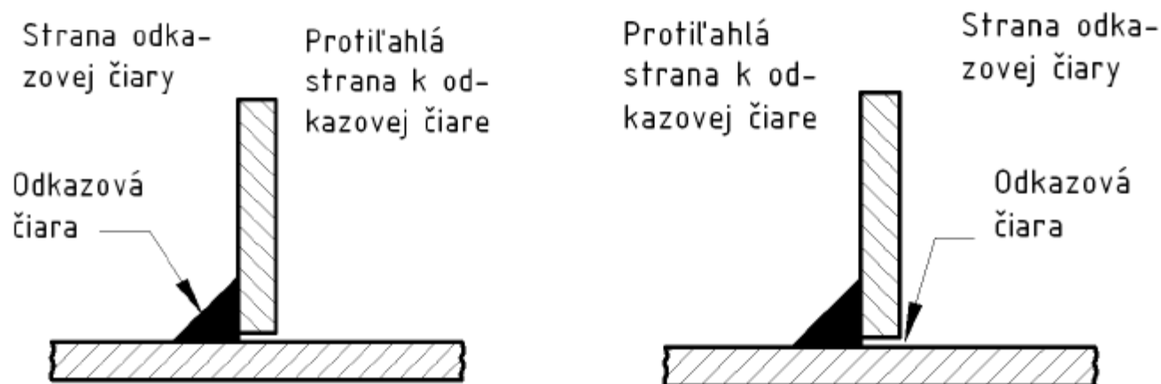
Obr. 3.6 Spoj T s kútovým zvarom – označenie zvaru
